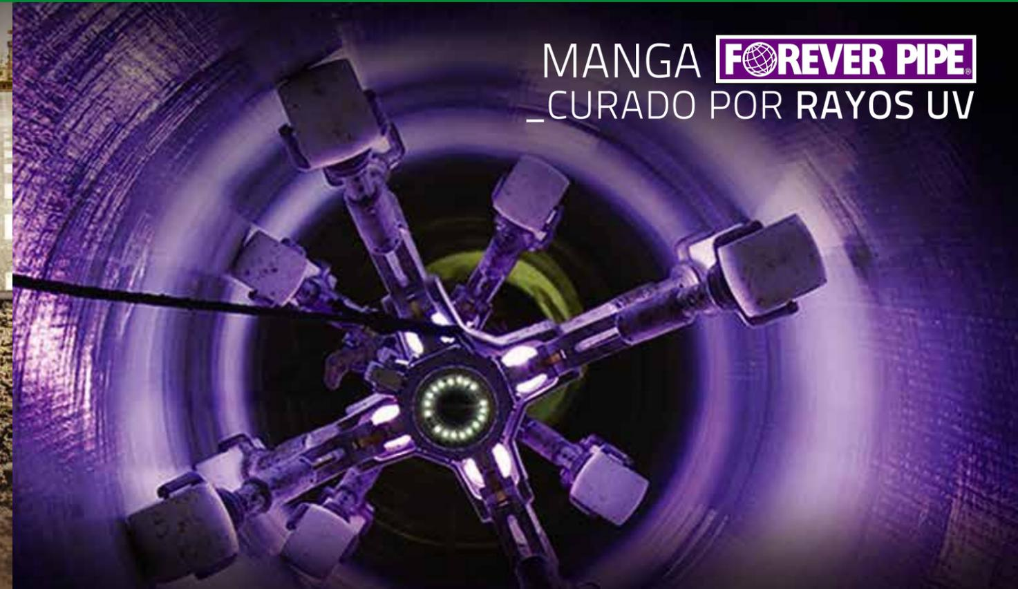
El método consiste en introducir por tiro en la cañería a rehabilitar una manga previamente impregnada con resinas, que luego se expande mediante la inyección por dentro de aire a presión, copiando la superficie de la tubería existente.
